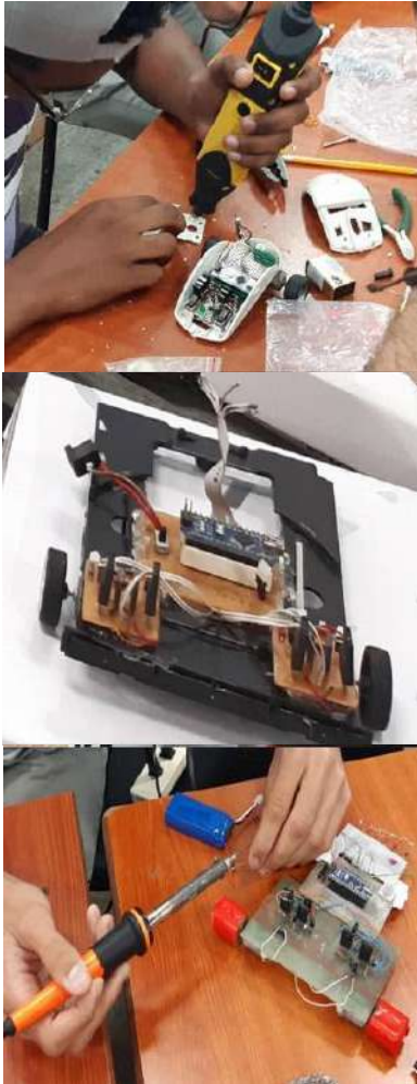
Figura 3: Curso de Electrónica Aplicada realizado con estudiantes de 1er Año de Ingeniería Automática para la confección de Robots Autónomos Seguidores de Línea a partir de componentes reciclados
